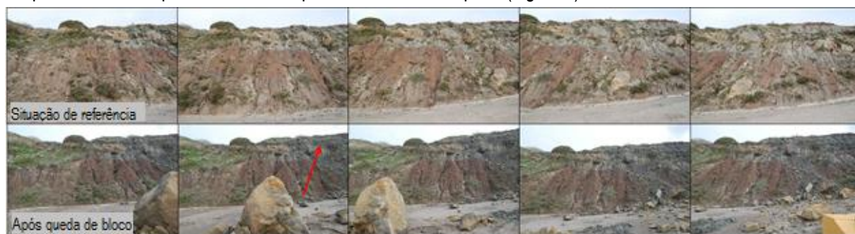
Figura 2 – Levantamentos fotogramétricos no talude de acesso à praia de S. Bernardino antes (em cima) e depois (em baixo) de uma queda de blocos na face da arriba
