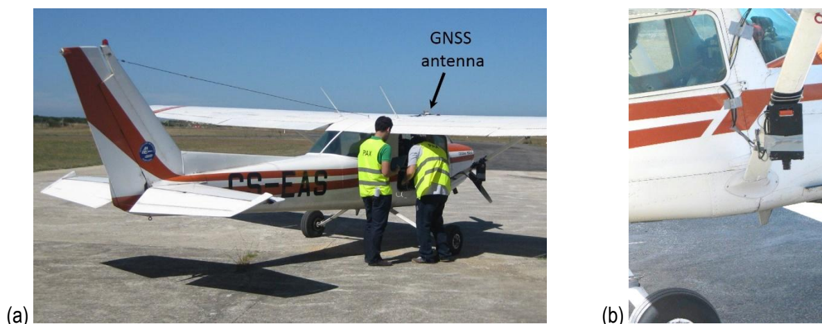
Figura 1 – Aeronave onde foi montado o equipamento: (a) antena de dupla frequência no topo, (b) caixa com a câmara no apoio da asa direita
