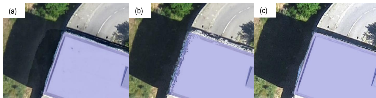
Figura 4 – Detalhe de ortomosaico de a) Agisoft Photoscan , b) Pix4Dmapper e c) MicMac .
