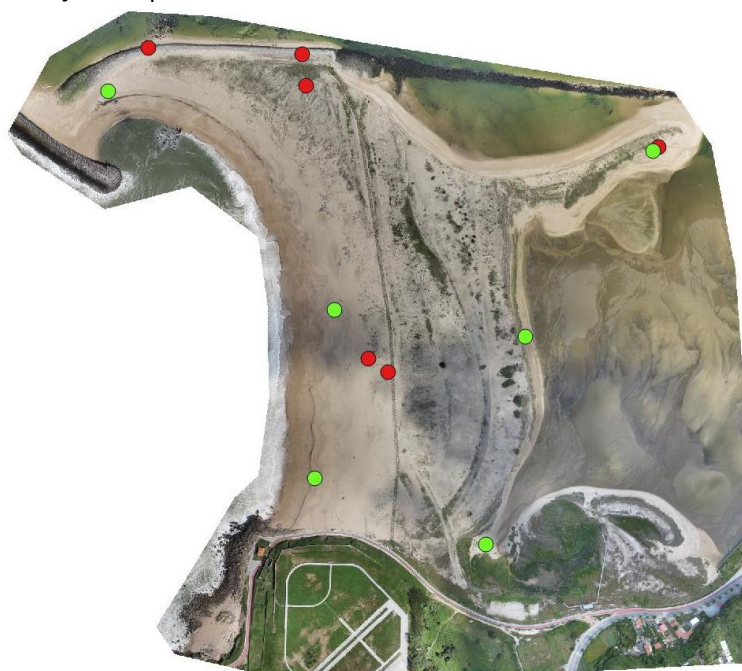
Figura 3 – Ortomosaico do Cabedelo com pontos de controlo a verde e de verificação a vermelho.
