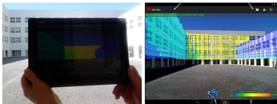
Figura 6 -Aplicação SolAR :Visualização de radiação nas fachadas em realidade aumentada
