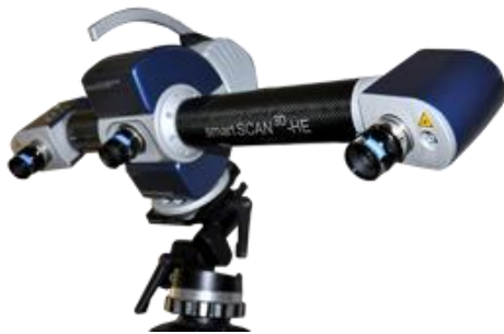
Figura 1 - Princípio de funcionamento do scanner fotogramétrico Breuckmann smartSCAN 3D-HE (Fonte: Manual do OPTOCAT)
