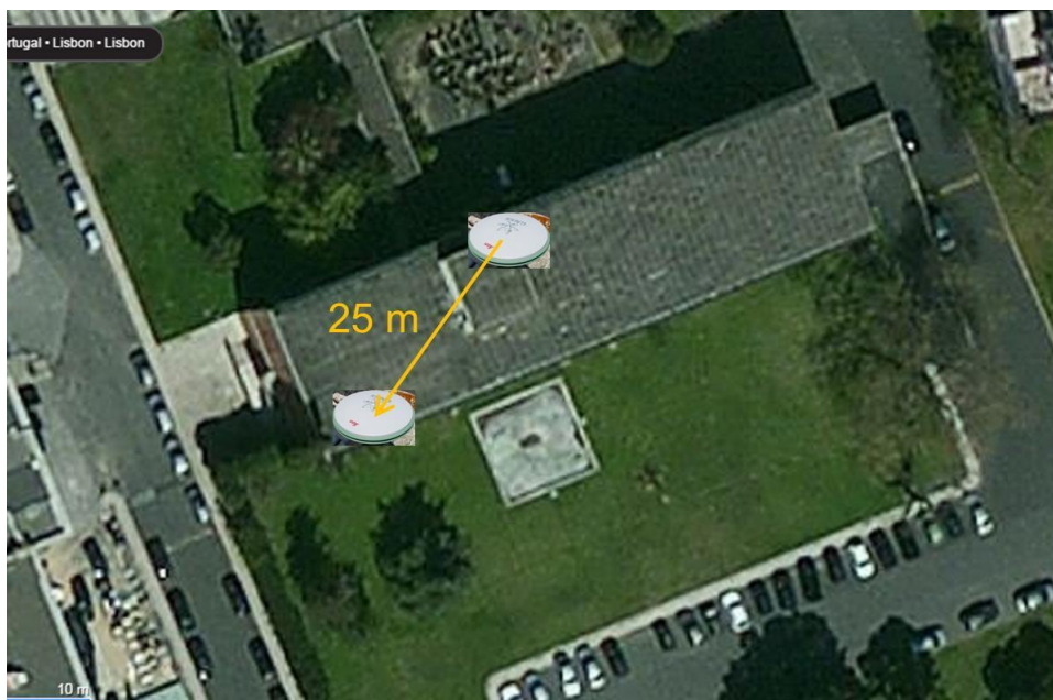
Figura 1 – Base de testes do LNEC, definida pela estação DBB1 e pela estação DBB3 (as antenas GNSS não estão à escala)
